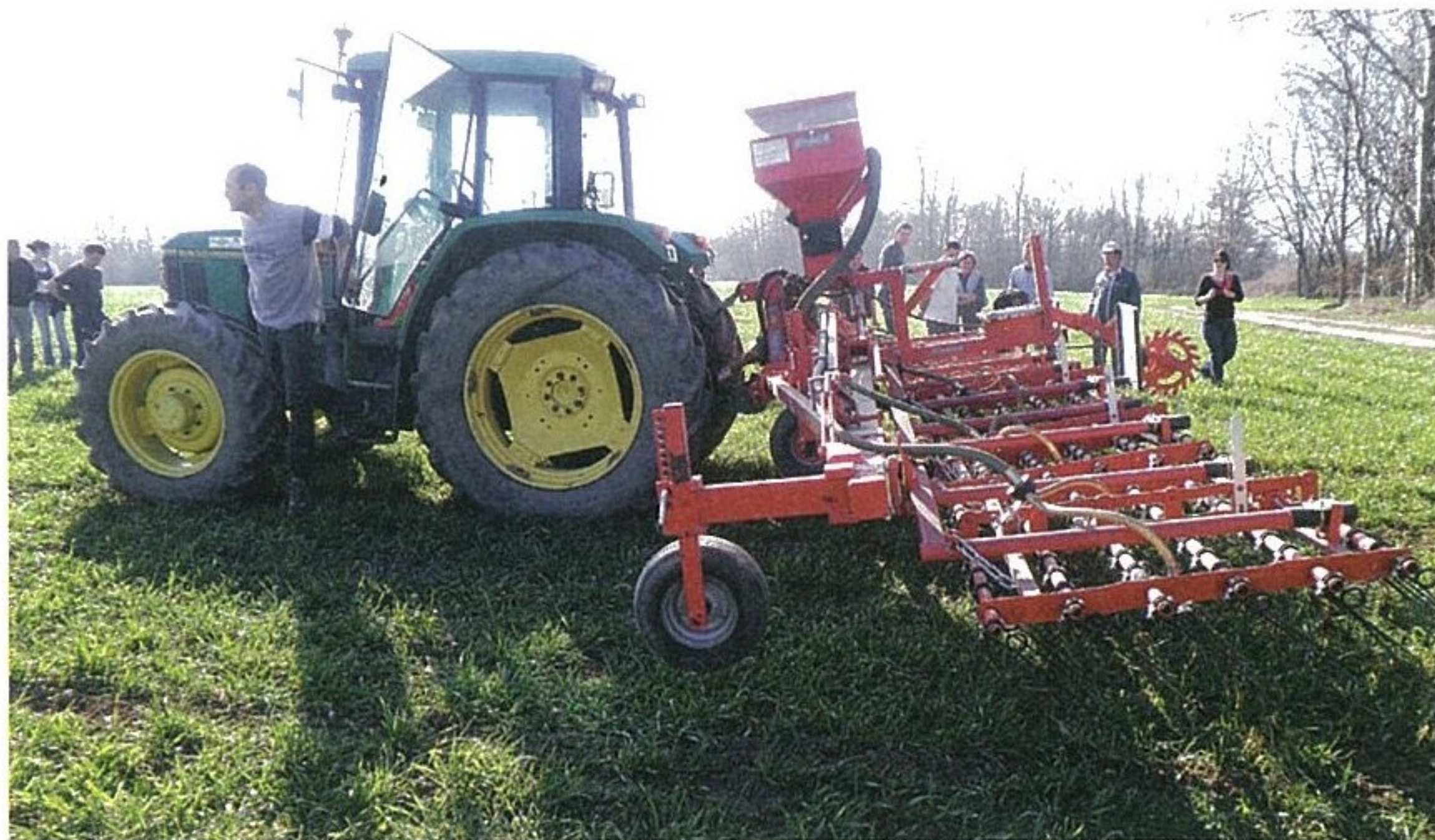
La herse étrille, avec semoir pneumatique intégré, a été achetée par le Symilav
